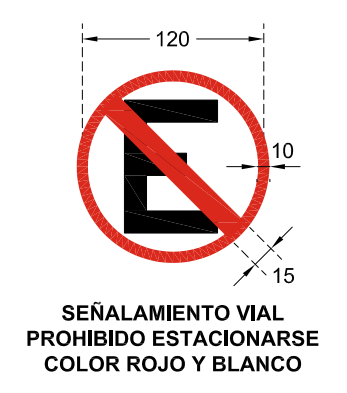
SEÑALAMIENTO VIAL PROHIBIDO ESTACIONARSE COLOR ROJO Y BLANCO
